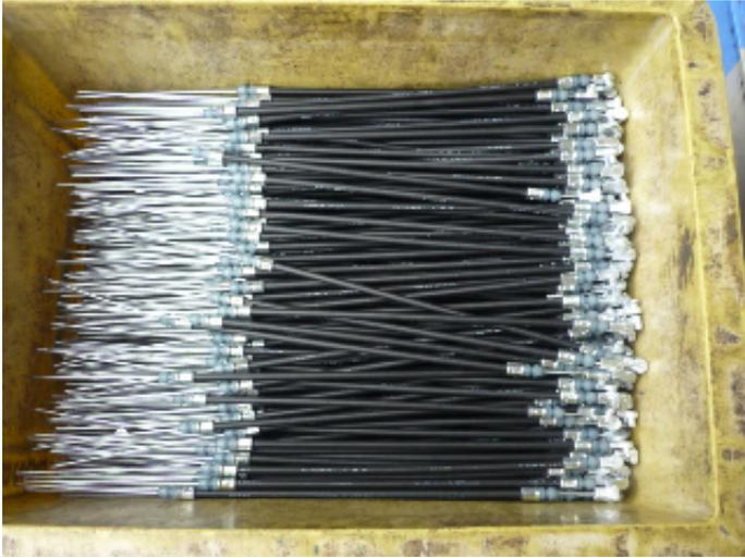
両サイドを機械で加締めして、インナー(銀色のワイヤー)を通す作業です。
